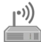
**Le routeur Wifi** permet tout comme le switch de relier plusieurs équipements mais avec une connexion sans fil en Wifi. Pour cela, il génère un sous-réseau local qui lui est propre (d'où le mot routeur)
