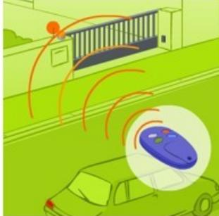
Le conducteur appuie sur la télécommande et envoie l'information d'ouverture du portail, Les ondes sont captées par l'antenne.
