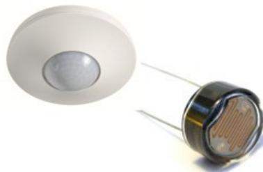
**Capteur de luminosité** indique le niveau variable d'intensité lumineuse
