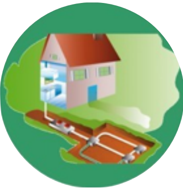
Géothermie horizontale (pompe à chaleur échangeur et serpentin)
