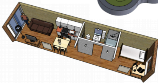
Aménagement d'un conteneur en logement étudiant
