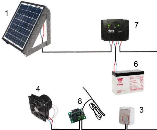
La batterie (6) et le panneau photovoltaïque sont branchés sur le régulateur (7). Celui-ci charge la batterie le jour, jusqu'à sa valeur maximale à partir de laquelle le régulateur coupe la charge.
